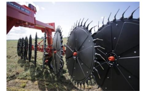
**HEAVY-DUTY FRAME WITH 60" (1.5 M) RAKE WHEELS**
