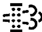
ICONCC058—UN—06JUN13 F1 - Automatic or Manual Regeneration Ongoing
