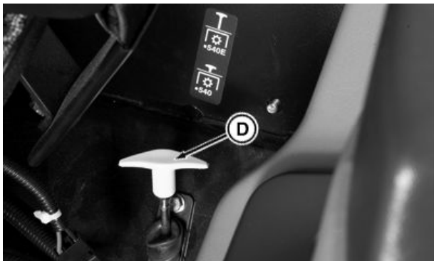
PTO 540/540E Shift lever (Cab Shown; IOOS Similar)
